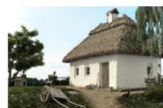
2. Чаще всего стены такого дома сложены из лёгкого и прочного плетня, состоящего из жердей, веток или камыша. Для прочности стены густо обмазаны глиной. Типичным является покрытие стен мелом или извёсткой, отчего они приобретают узнаваемый белый цвет. Крыша может быть соломенной или камышовой. Практически всегда одноэтажные.
